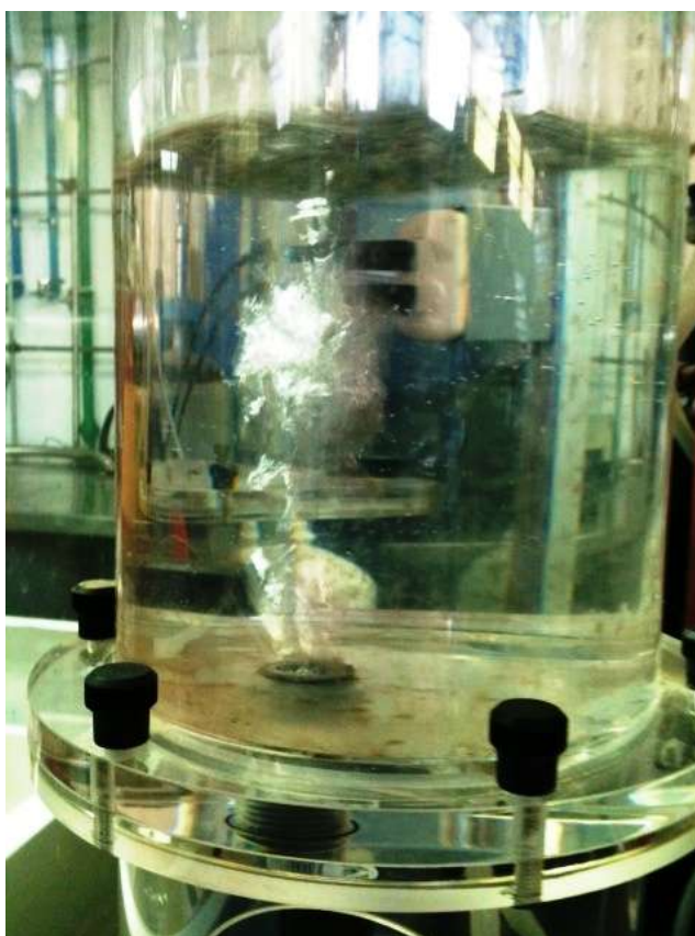
Gráfica 28. Observación de las burbujas de gas producido en el digestor en la columna medidora con agua
