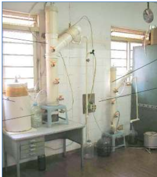
Gráfica 27. Reactores UASB operados en serie
