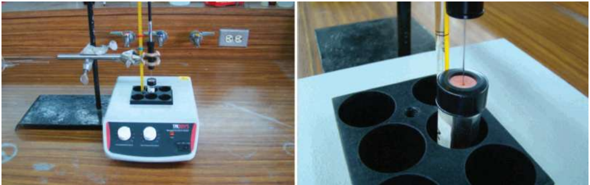
Gráfica 19. Sistema de adsorción de los compuestos volátiles aromáticos del café
