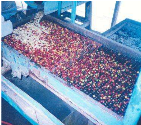
Gráfica 3. Clasificador de grano despulpado
