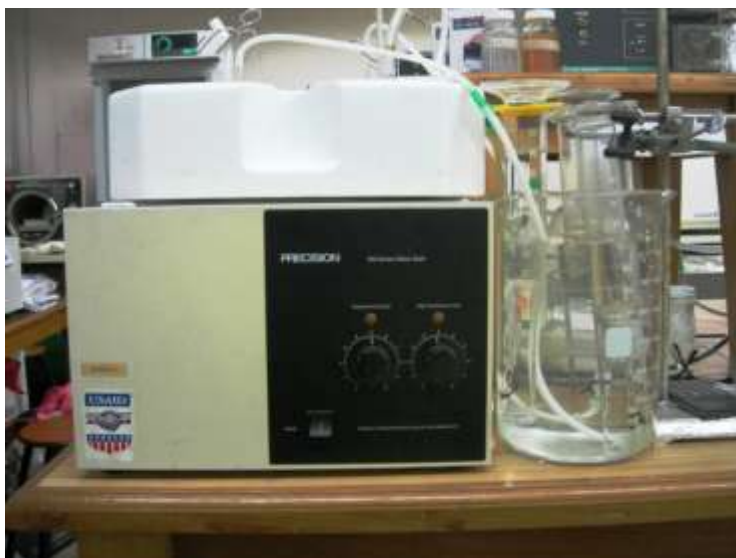
Gráfica 25. Probeta invertida para verificar la producción de gas
