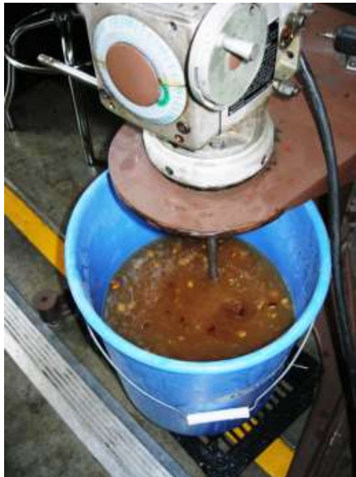
Gráfica 17. Mezclador piloto empleado para lavar el café fermentado.
