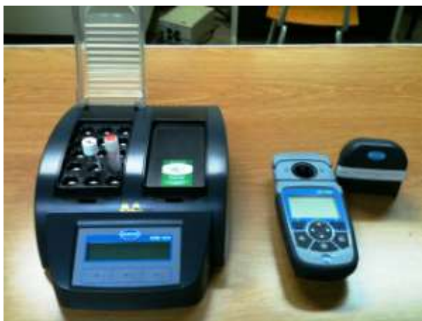
Gráfica 21. Sistema de medición del DQO
