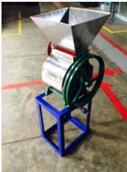
Gráfica 12. Pulpero piloto operado manualmente
