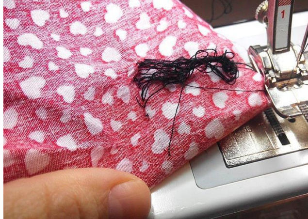
Fuente: Máquina presenta costuras y pérdidas de hilo
