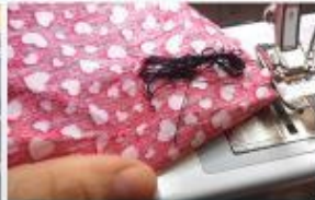
Máquina presenta malas puntadas y pérdidas de hilo
